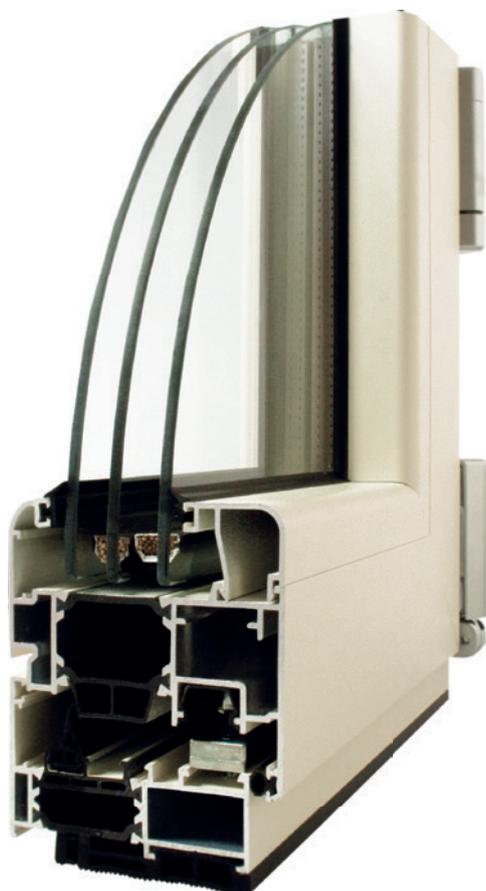
Sistema di tenuta a giunto aperto. Ferramenta perimetrale a nastro. Taglio termico con barretta continua in PA 6.6 + FG 25% da 36 mm.
